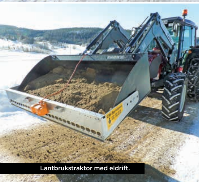
Spår alt. ensidessandning med lösa plåtar.
